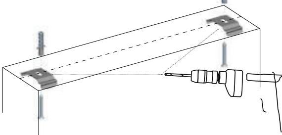
Agganciare il prodotto alle clip, così montato e forare in direzione dei fori all'interno delle guide, bloccare con le viti.
