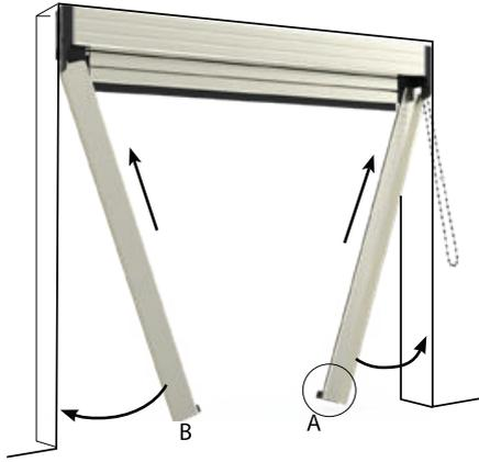
**D** Forare e fissare con viti e tasselli in dotazione all'interno delle guide
